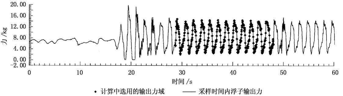
图 3 浮子输出力曲线 (  $T = 1.887s$  )
